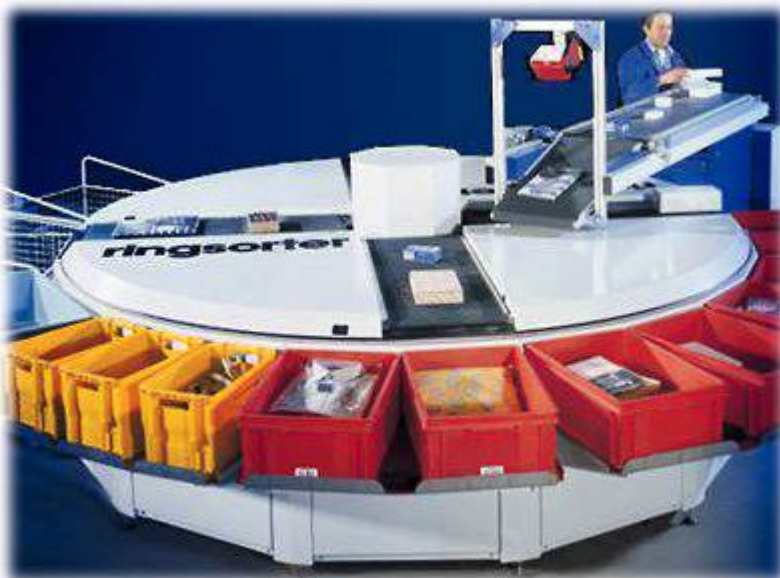
Figuur 6. Ringsorter van PSB, waarmee in batch verzamelde artikelen automatisch in de klantenbak worden gesorteerd. Zodra de order compleet is, wordt de bak automatisch vervangen door een nieuwe. Bron: PSB.
