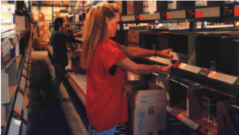
Figuur 5. Pick-to-light systeem. De verzamelaar verzamelt vanuit de doorrolstellingen met stellingdisplays rechtstreeks in de klantverpakking. Bron: Vanderlande Industries.
